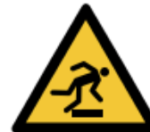
Warnung vor Hinder- nissen am Boden
